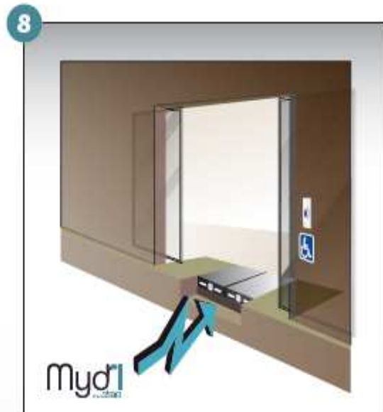
8 - Répéter les manoeuvres précédentes en sens inverse pour fermer la rampe
