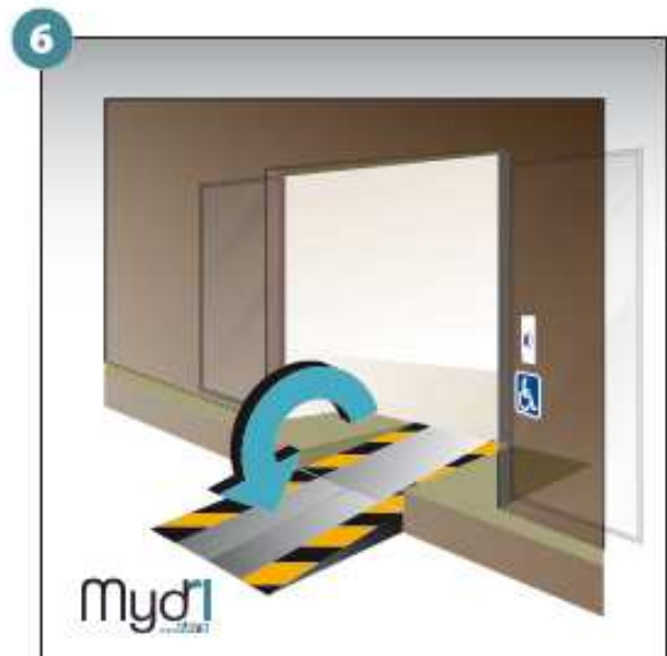
6 - Répéter les opérations pour la deuxième rampe.
