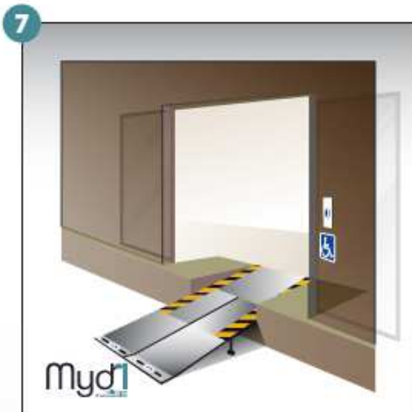
7- Rampe en service
