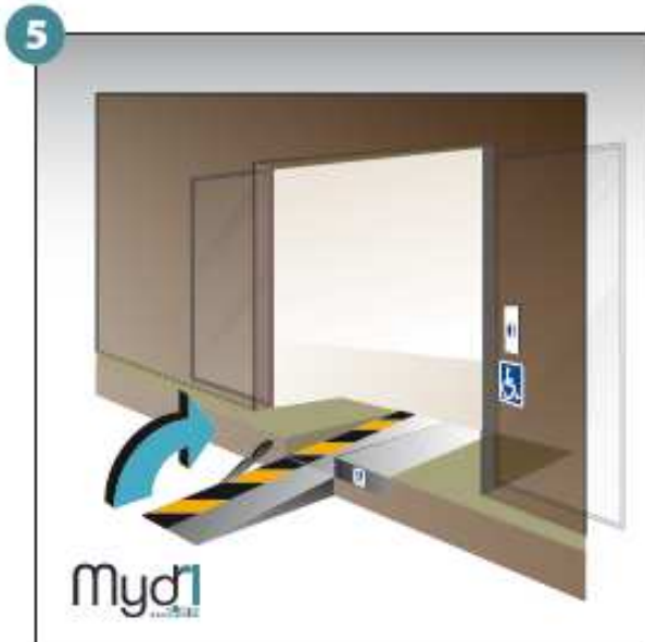
5 - Basculer la poignée qui fera office de chasse roues.
