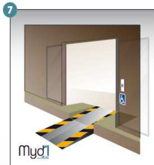
7- Rampe en service.
