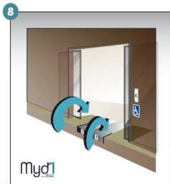
8 - Répéter les manoeuvres précédentes en sens inverse pour fermer la rampe.
